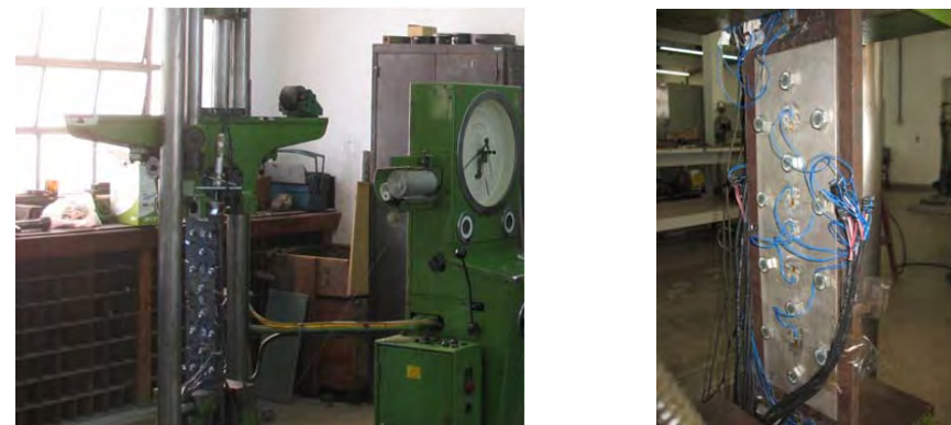
a) universal test machine, 600kN
